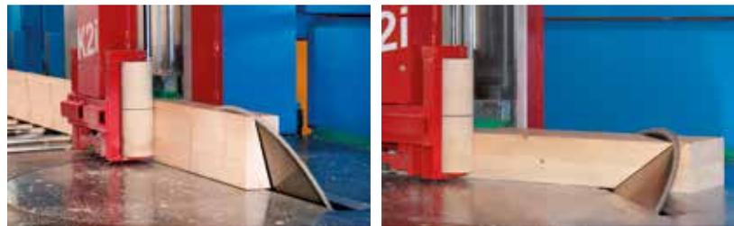
Längs-, Winkel-, Schifterschnitte
