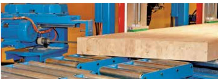
360° Schwenkbares Tieflochbohrgerät bis 1250 mm
