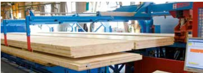
Automatisches Einfördersystem auch für Leimholzplatten
