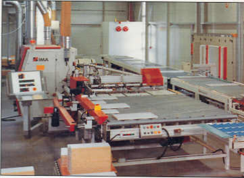
Vakuum-Einschubtisch zum winkelgerechten Einführen unterschiedlich großer Werkstücke.
