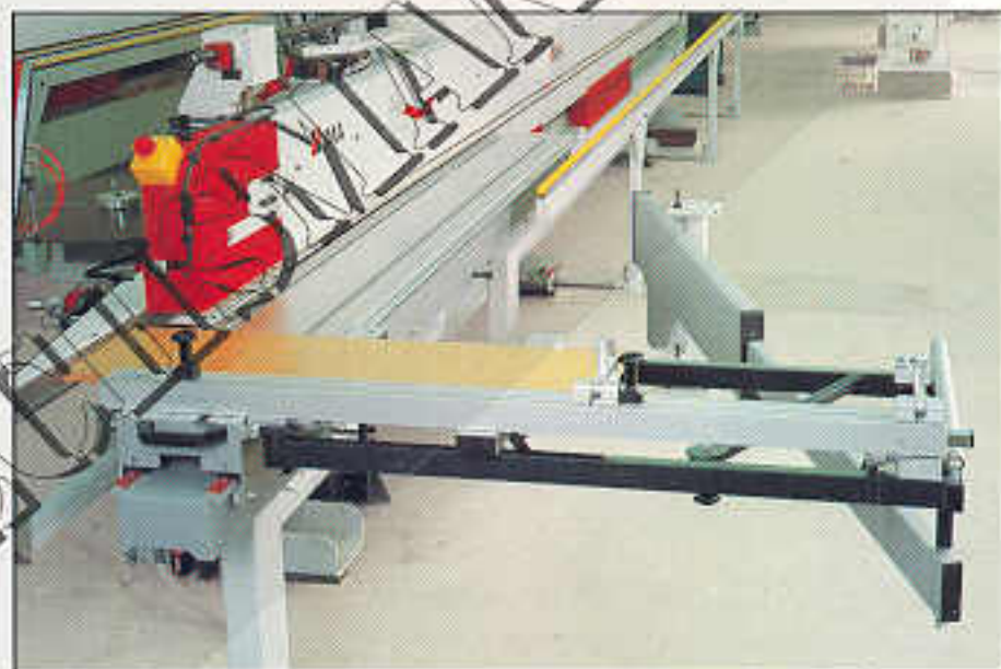
Einschubtisch zur manuellen Zuführung schmaler Werkstücke (Querbearbeitung).
