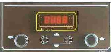
LED-Digitalanzeige für Werkstück-Dickeneinstellung.
