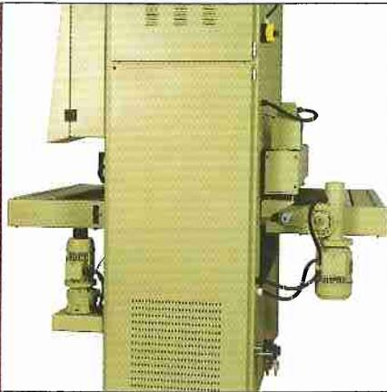
Tischverlängerung am Ein- und Auslauf, Motor zur Tischhöhenverstellung mit Handrad zur Dickenfeineinstellung. Antrieb für Transportteppich mit zwei Geschwindigkeiten.
