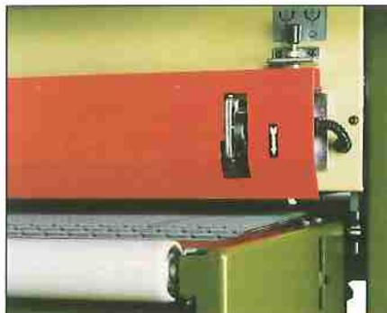
Rückseite der Compact 1 K 1030 mit Rolle an der Auslauf-Tischverlängerung. Bürstenwalze zur Werkstückreinigung (auf Wunsch).
