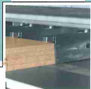
Pinze ad un'unghia di bloccaggio, con compensazione in altezza.
