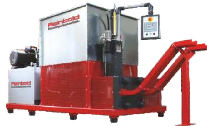
La prensa de briquetas RB 400 RS tiene una técnica de briquetado segura y potente para la fabricación de briquetas cuadradas para la reducción del volumen y el aprovechamiento térmico. La excelente densidad de la briqueta cuadrada es ideal para el almacenamiento o el transporte. Además, las briquetas de alta compactación tienen un excelente comportamiento de combustión.
