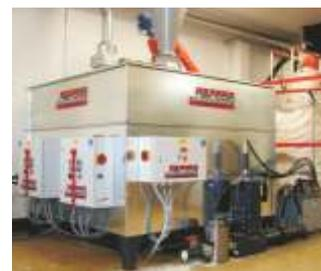
Prensa briqueteadora tándem con gran depósito (flexible)
