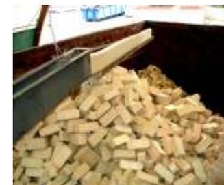
Muchos materiales, como recortes de madera dura o blanda, productos cepillados, serrín y polvo de esmerinado, pueden prensarse en combinación con otros materiales, como papel, paja y Styropor. La humedad máxima del material no debería sobrepasar el 18 %.
