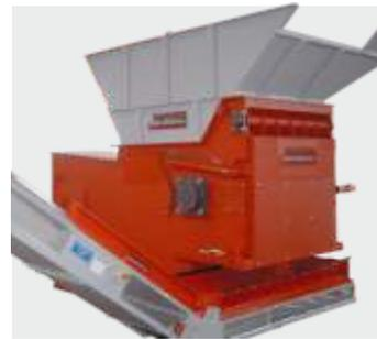
Serie AZR Gigant con cesta filtrante pivotante hidráulicamente y cinta transportadora opcional como salida
