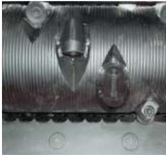
Rotor perfilado con portacuchillas soldados y cuchillas circulares de 30 mm
