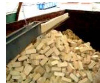
De nombreux matériaux sont compactables, tels que: les bois durs et tendres, les copeaux et rognures, les sciures et les poussières de ponçage mélangées avec d'autres matières, matériaux dérivés du bois, panneaux en aggloméré, contreplaqué... Le taux d'humidité maximal ne doit pas excéder 18 %.
