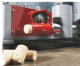
La série RB 20 - 60 SV dispose aussi d'un système de contrôle en continu de la longueur des briquettes.
