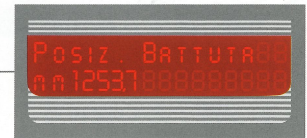
The system indicates where to position the stop on the fence to obtain the required measurement. Das System zeigt an, wo der Anschlag zu positionieren ist, um das gewünschte Maß zu erhalten.
