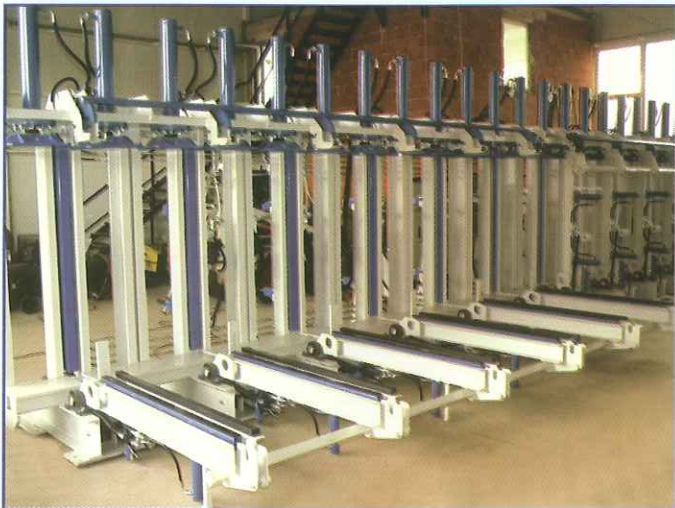
Gluelam press Presse für Leimbinder Strettoi per l'incollaggio di travi Presse pour lamellés collés Prensa para el encolado de vigas
