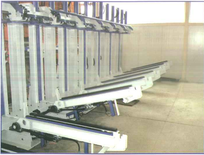
Press in the position of filling and discharging Die Presse in der Lage für Be- und Entladung Strettoio in posizione di riempimento e svuotamento Presse en position de remplissage et de vidange Prensa en la posición de llenado y vaciado
