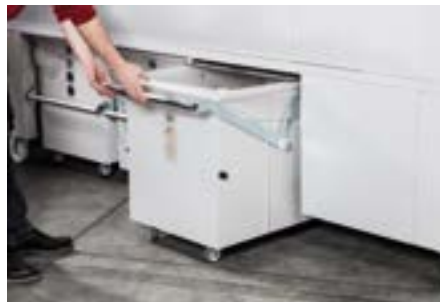
Spänebehälter wieder einsetzen und Staubschott entfernen
