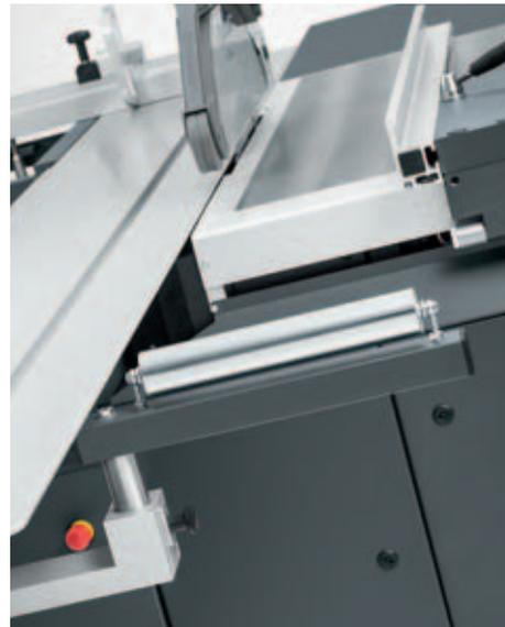
**Vordere Auflagerolle:** Die vordere Auflagerolle ist mit einer Breite von 300 mm beim Schneiden langer Werkstücke am Parallelanschlag eine hilfreiche Unterstützung. Sie kann mit einem Handgriff um 90° unter den Doppelrollwagen (Mindestlänge 3000 mm) positioniert werden.
