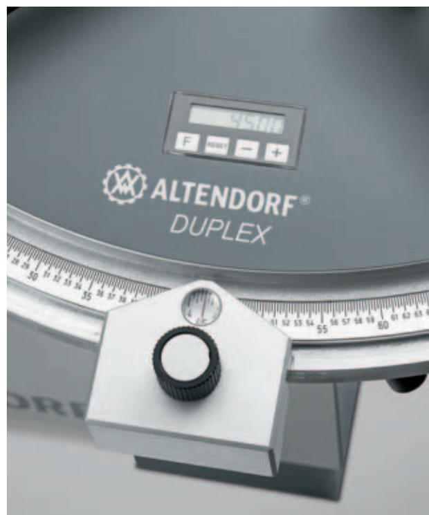
**DUPLEX DD:** Der DUPLEX DD ist weltweit patentiert. Die großen Vorteile: Aufwendiges Umrechnen und Nachmessen sowie Probeschnitte entfallen. Die exklusiv von Altendorf entwickelte, hochpräzise elektronische Einheit des DUPLEX DD errechnet das Längenmaß in Abhängigkeit zum Gehrungswinkel auf beiden Seiten des Anschlags und zeigt beide Werte digital an. Einstellbar über digitale Winkelanzeige und digitale Längenanzeige mit automatischem Längenausgleich. Inkl. Batterien.
