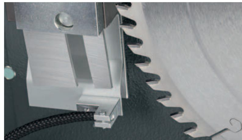
**Sprühvorrichtung:** Für Kunststoffe mit niedrigem Schmelzpunkt und bestimmte Leichtmetalllegierungen ist eine Sprühvorrichtung empfehlenswert. Ihre Altendorf schneidet so Aluminium und Kunststoffe sauber, kantenscharf und zehntelgenau.
