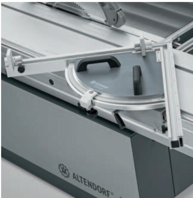
**DUPLEX D:** Die Funktionalität entspricht dem DUPLEX. Der DUPLEX D ist jedoch mit einer digitalen Winkelanzeige ausgestattet, die die Werte mit einer Genauigkeit auf 1/100° anzeigt.
