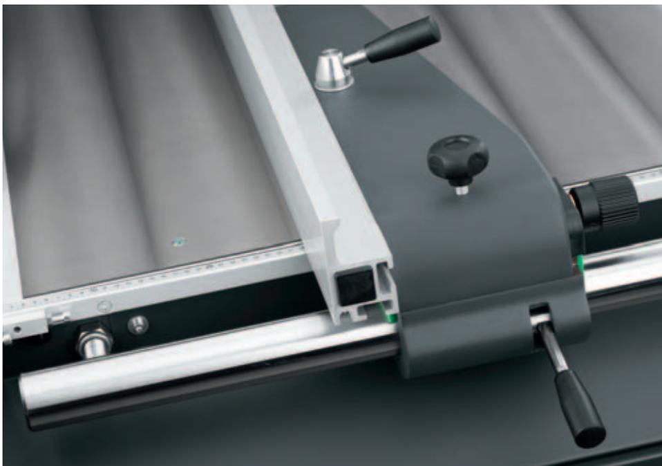
**Parallelanschlag mit manueller Feineinstellung:** Der Anschlag ist leicht zu verstellen und dank der Feineinstellung sehr präzise manuell zu justieren. Die Leichtgängigkeit erhält der Anschlag über das hart verchromte Rundstangensystem. Sollen große Platten aufgeteilt werden, kann der Anschlag mit einem Griff unter die Tischebene geschwenkt werden.
