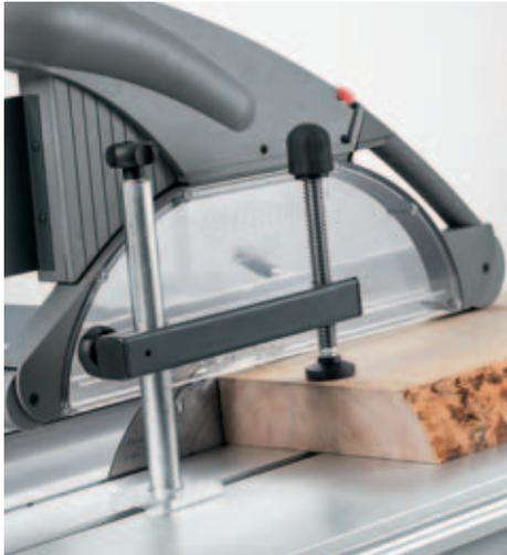
**Manueller Schnellspanner:** Die Alternative zum pneumatischen Schnellspanner. Der manuelle Schnellspanner ist mühelos auf dem Doppelrollwagen positionierbar und lässt sich ebenso leicht fixieren, womit das Werkstück unverrückbar auf dem Wagen und am Winkelanschlag liegt. Spannhöhe bis 200 mm. Ein Mehr an Sicherheit, das nicht viel kostet.
