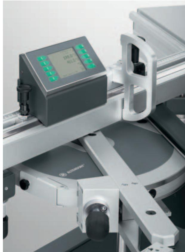
**DIGIT L:** Zum 1/10 mm genauen Einstellen des Längenmaßes. Das Display zeigt alle eingestellten Klappenmaße an. Durch die zentrale Mess- und Anzeigeeinheit wird mit einem einzigen Kalibriervorgang das komplette System geeicht. Mit integriertem, manuellem Längenausgleich. Zwei Einzelkippschläge mit Feineinstellung und zwei leistungsfähige Akkus mit Ladegerät inklusive.
