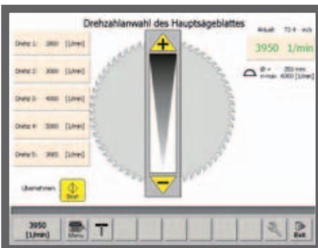
**VARIO Antrieb für einseitige Schwenkung:** Dieser Antrieb regelt die Drehzahl stufenlos von 2 000–6 000 U/min. Durch die exakte Drehzahlanpassung an das Material erhöhen sich die Schnittqualität sowie die Standzeiten der Sägeblätter – was wiederum Ihre Kosten reduziert.
