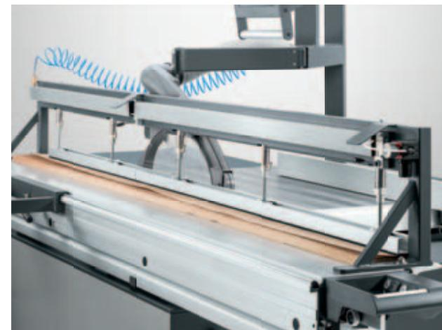
**Pneumatischer Druckbalken:** Ideal zum sicheren Spannen von Werkstücken bis 80 mm Dicke und deshalb besonders vorteilhaft bei langen und dünnen Materialien wie z. B. Furnieren. Zweigeteilt und getrennt steuerbar. Benötigt Pneumatikanschluss mit 6 bar.
