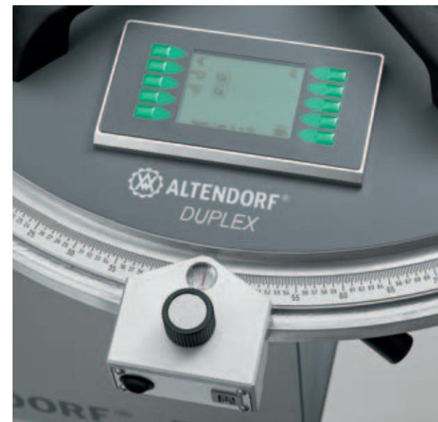
**Doppelseitiger Gehrungsanschlag DUPLEX:** Die DUPLEX Anschläge erlauben Winkelschnitte von 0–90° sehr schnell, genau und stufenlos. Bei einer Einstellung von 45° kann die Gehrung beidseitig am Werkstück ohne weitere Verstellungen geschnitten werden. Die Maßeinstellung der Anschlagklappen erfolgt über Maßskala und Lupe, inkl. Längenausgleich. Alle DUPLEX Varianten sind problemlos auf der gesamten Wagenlänge positionierbar.
