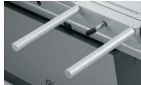
**Vorlagenhalter:** Praktisch ist der Vorlagenhalter direkt an der Steuerung in Augenhöhe. Die Stücklisten werden durch eine Klemmung fixiert, so haben Sie Ihre Aufträge permanent im Blick.
