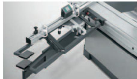
**Querschlitzenverbreiterung:** Die feste Querschlitzenverbreiterung bis zu 650 mm mit zwei separaten Auflagen erleichtert das Sägen breiterer bzw. längerer Werkstücke.
