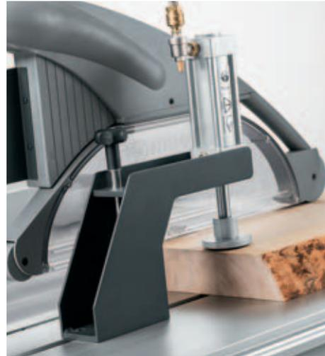
**Pneumatischer Schnellspanner:** Sichert die Auflage des Werkstücks auf dem Doppelrollwagen. Drahtlos per Funkfernbedienung gesteuert, erzeugt der Schnellspanner eine Spannkraft von max. 1000 N. Das Werkstück liegt unverrückbar am Winkelanschlag an. Werkstücke bis max. 170 mm Stärke können gespannt werden. Mit einer oder zwei Spannvorrichtungen lieferbar. Pneumatikanschluss (6 bar) ist kundenseitig zu stellen.
