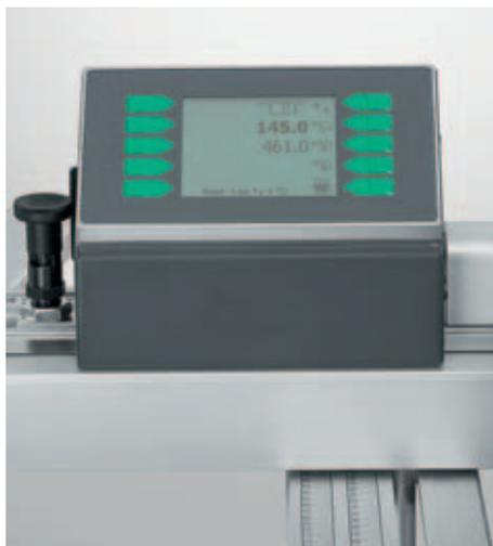
**DIGIT L:** Zum 1/10 mm genauen Einstellen des Längenmaßes. Das Display zeigt alle eingestellten Klappenmaße an. Durch die zentrale Mess- und Anzeigeeinheit wird mit einem einzigen Kalibriervorgang das komplette System geeicht. Zwei Einzelkippsanschläge mit Feineinstellung, zwei Akkus und Ladegerät inklusive.
