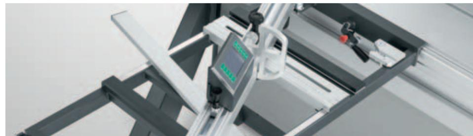
**DIGIT L:** Zum 1/10 mm genauen Einstellen des Längenmaßes. Das Display zeigt alle eingestellten Klappenmaße an. Durch die zentrale Mess- und Anzeigeeinheit wird mit einem einzigen Kalibriervorgang das komplette System geeicht. Zwei Einzelkippanschläge mit Feineinstellung, Ladegerät und zwei leistungsfähige Akkus inklusive.
