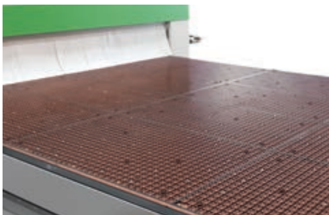
Piano di lavoro in fenolico stratificato con sistema del vuoto.
