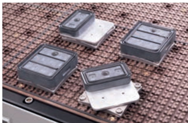
Moduli vacuum liberamente posizionabili sul piano di lavoro FT senza l'ausilio di connessioni dedicate.
