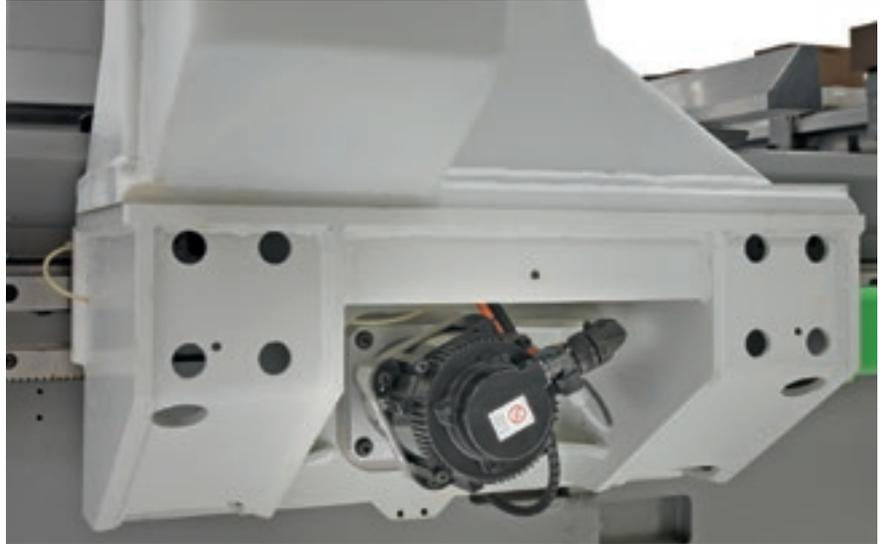
La **doble motorización en el eje X** permite alcanzar altas velocidades y aceleraciones, manteniendo una alta precisión y calidad de acabado.
