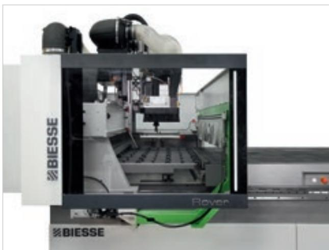
La banda de leds de 5 colores que indican el estado de la máquina en tiempo real ayudan al operario a controlar el estado de la máquina en cualquier momento.
