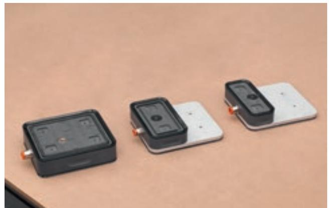
Los **módulos de vacío** se pueden colocar directamente en el panel mártir. Los módulos se pueden utilizar de forma rápida y sencilla sin necesidad de un sistema de vacío auxiliar.
