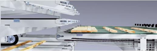
Der starke Beschleuniger versorgt den Scanner mit Nachschub. Geschwindigkeiten von über 270 m/min gewährleisten die zuverlässige Beschickung der Kappsägen. Die massive Ausführung garantiert einen vibrationsarmen Transport und damit hohe Erkennungsleistungen im Scanner. Ausgeklügelte Mechanisierung und automatisches Stapeln sorgen für höchste Produktivität.
