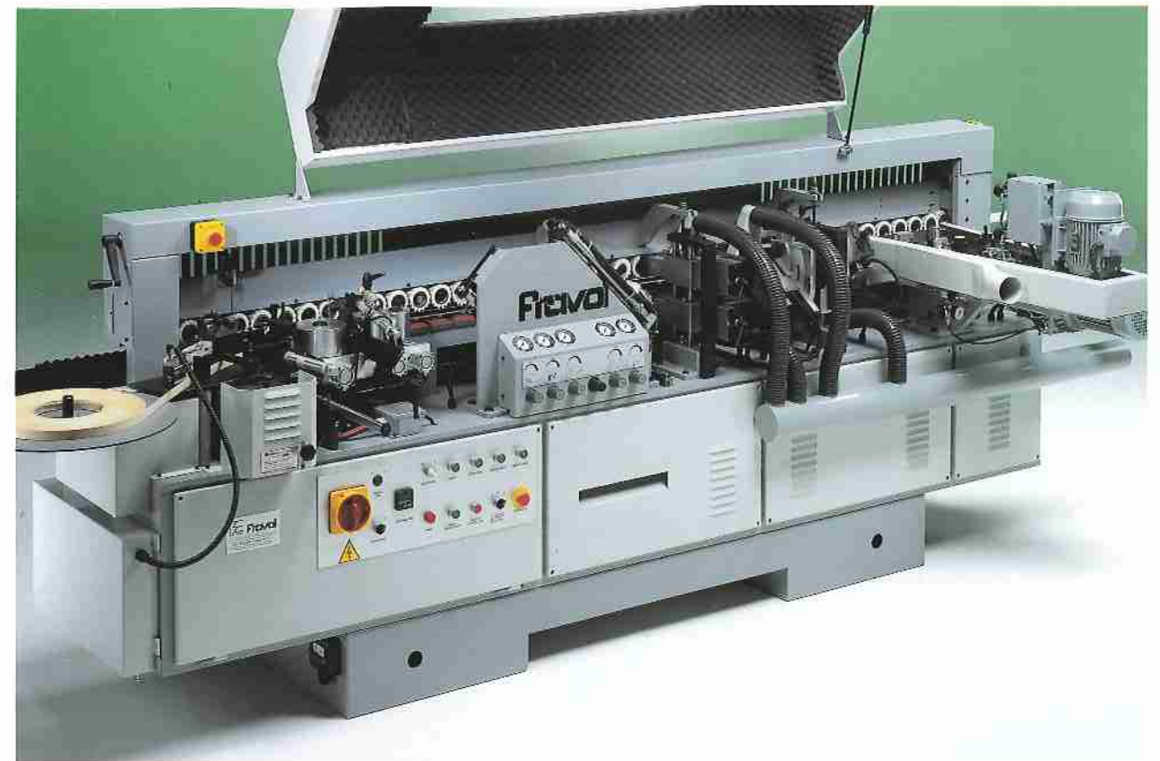
RAPID-R4 Borda/Intesta/Rifila/Spigola + Acc. n. 12 Edges/End-Trims/Trims/Fine-Finishes + Acc. n. 12 Encoller/Abouter/Affleurer/Superfinir + Acc. n. 12 Anleimen/Kappen/Bündigfräsen/Feinfräsen + Zubehör n. 12 Encola/Retesta/Perfila/Acabado Fino + Acc. n. 12
