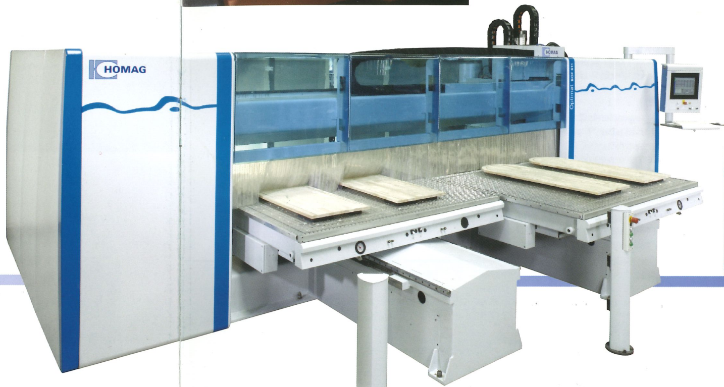
Bearbeitungszentrum Optimat BOF 611 mit optionaler Vollkapselung
