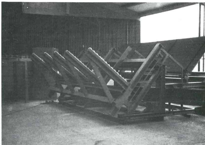
Aufsetzen verschiedenster Stapellängen möglich durch speziell auf Ihre Ansprüche abgestimmten Entstapelungstisch.
