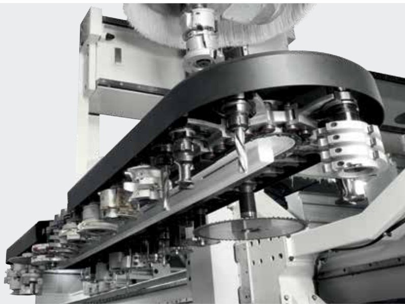
Magasins porte-outils disponibles avec au maximum 48 positions pour chaque groupe d'usinage.
