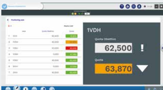
MDI-Funktion (Memory Data Input) zur geführten manuellen Einstellung der Achsen.
