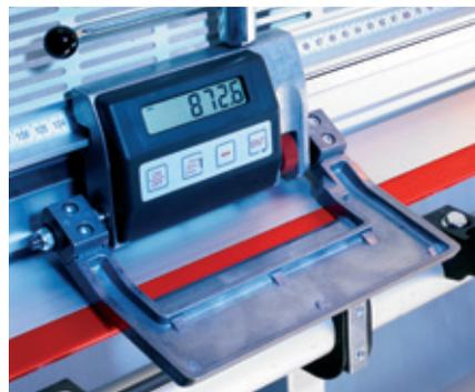
Das Digitale-Mess-System DMS hat eine wählbare Anzeigegegenauigkeit von 1,0/0,5 und 0,1mm. Es ermöglicht ein schnelles und sehr komfortables Bedienen und spart jede Menge Zeit. Das System ist für Rollen- und Mittelauflage und auch für Streifenschnitte einsetzbar.
