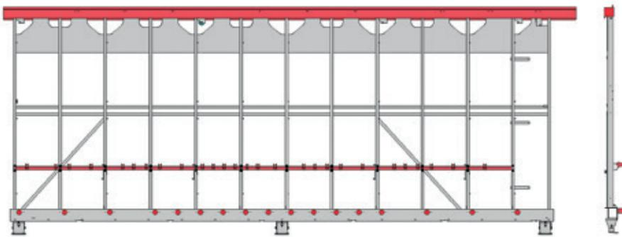
Selbsttragend, festverschweisst und mit gehärteten Führungen ausgestattet – das zeichnet den Sägerahmen der STANDARD schon immer aus. Dieser Rahmen, das Herzstück jeder Stribig-Plattensäge, wurde im Laufe der Jahre immer weiter verbessert. Die absolute Parallelität zwischen der oberen Führungsschiene, der Mittel- und der Rollenaufgabe sichert die Schnittpräzision über viele, viele Jahre. Stribig bietet Ihnen damit eine Investitionssicherheit, die nur noch selten zu finden ist.
