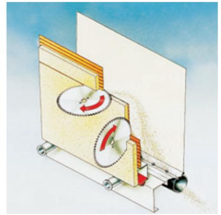
Da wir um die hohe Staubsensibilität in vielen Unternehmen – besonders zum Beispiel im Baumarktbereich – wissen, bieten wir die STANDARD in zwei verschiedenen TRK-Ausführungen an. Mit der integrierten TRK-Staubabsaugung erreichen wir Staubgrenzwerte von deutlich unter  $1 \text{ mg/m}^3$  (TRK1). Die gültigen TRK-Richtwerte unterschreiten wir damit um mehr als 50 %.
