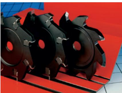
Mit speziellen Hartmetall-Wendepalten-Profilfräsern werden auf der Rückseite der Verbundplatten V- oder U-förmige Nuten eingefräst. Die Nutform bestimmt den Biegeradius.
