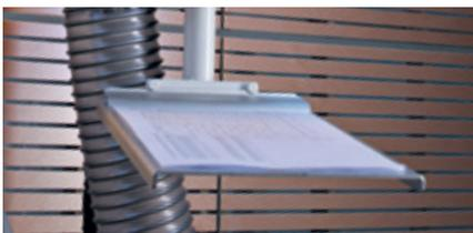
Sicher gehalten - der Papierhalter hält die Arbeitsunterlagen direkt an der Sägebedienug griffbereit.
