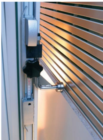
Der serienmässig eingebaute Streifenanschlag mit Kanten schonender Rollenauflage erleichtert Wiederholschnitte.
