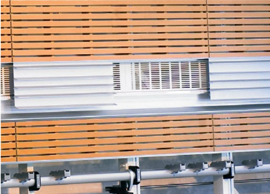
Die serienmäßige Kleinteileauflage aus Aluminium hält die Werkstücke sicher und flatterfrei. Als Option ist die Kleinteileauflage auch in Holz-Ausführung lieferbar. Kleinteile können so in optimaler Arbeitshöhe ohne Schwierigkeiten bearbeitet werden.
