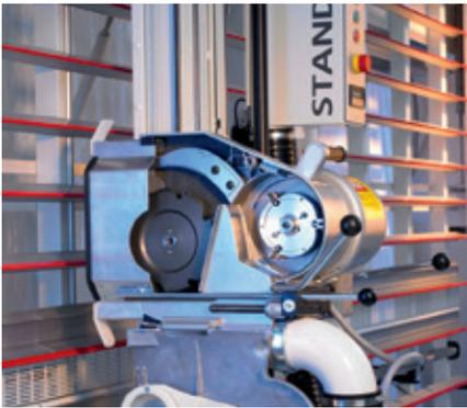
Nut- und Fräsarbeiten sind bei vielen Aufträgen unbedingt notwendig. Auf der STANDARD können diese Arbeiten problemlos ausgeführt werden. Sie können Holzwerkstoffe und Verbundplatten verarbeiten. Mit unseren unterschiedlichen Zubehörpaketen – Nutvorrichtung für Verbundplatten, Tiefenanschlag für Verstellnutwerkzeuge, Wendepalten-Profilfräser und Wendepalten-Verstellnuten – stellen Sie sich Ihr individuelles Zubehör für diese Arbeiten ganz einfach zusammen.
