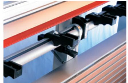
"High-End"-Raster aus faserverstärktem Kunststoff-Material bieten besonders empfindlichen Kantenmaterialien und Postforming-Kanten einen speziellen Schutz.
