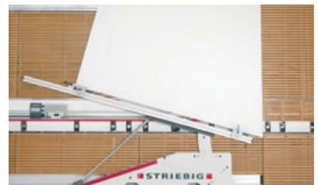
Das Winkelschnittgerät WSG kann links und rechts neben jeder vertikalen Schnittstelle eingesetzt werden. Es ist einfach und schnell montiert. Mit der integrierten Mess-Skala kann die Werkstück-Kantenlänge stufenlos eingestellt werden.
