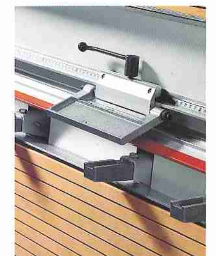
Stabiler Längenschnittpunkt mit griffgerechtem Bedienungshebel.
