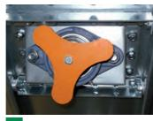
3 Надежность Увеличение защиты от отключений при помощи системы контроля за скребковым транспортером и шлюзовым дозатором посредством индуктивных датчиков (Опция).
