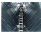
4 Надежная выгрузка с помощью качественной цепной системы: усиленное исполнение, борьба с «мостиками» отходов, с самонатяжением и без постоянного обслуживания. Пониженный износ благодаря высокому углу наклона контейнера и сменным элементам пола.
