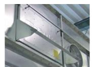
6 Взрывовыпускные панели с отводом пламени облегчает выпуск давления при возможном взрыве. Высокий уровень безопасности возможен благодаря использованию датчиков контроля за установкой и устройству аварийного выключения.
