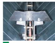
4 Выгрузка материала Тихая выгрузка опилок благодаря оптимизированной системе снижения вибрации. Увеличенный диаметр приводных валов, массивный звенья цепи из серого чугуна для долговечности работы.
