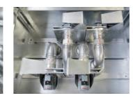
Каскадная система служит для снижения потребления электроэнергии и повышения надежности установки. Вентиляторы мощностью 4 - 5,5кВт включаются и/или выключаются поочередно в зависимости от нагрузки (Опция).
