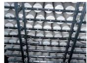
2 Увеличенная площадь фильтров улучшает бесперебойную работу аспирации. С **у**величением площади фильтров на 21% на каждый элемент возможна более эффективная нагрузка на фильтры и увеличивается срок службы фильтров
