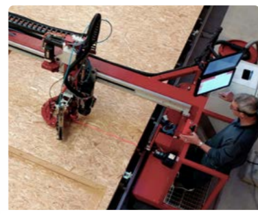
Klammergerät Immer kontrollierter Klammerabstand. Erspart Einmessen, Anzeichnen und Nachladen
