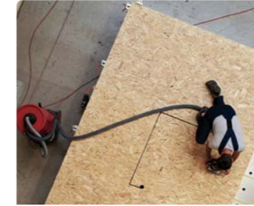
Plattenfräser Staubfreier und effizienter Plattenzuschnitt ohne Einmessen und Anzeichnen
